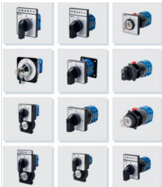
所谓的自复式，则是把手柄拨到某一个方向档位时，手松开之后，手柄有回复原位；自定位则是手柄拨到某一个位置，不能进行自动的复原，而是定在这个位置。而LW6系列的转换开关，适用在，可以进行逆向操作。转3c谁知道a1自动转换开关的价格贵不贵据我所知，转换开关盒的价格比较贵[]4LW5系列转换开关的电气符号及其工作原理转换开关是一种具有多个操作位置，能够换接多个电路的一种手动电器。转换开关由凸轮机构、触头系统和定位装置等部分组成。依靠操作手柄带动转轴和凸轮转动，使触头动作或复位，从而按所需要的规律接通或断开电路，同时由定位装置确保其动作的准确可靠。常用的转换开关有LW5[]LW6[]LW8等系列。其中LW6系列还可装配成双列形式，列与列之间用齿轮啮合，并由公共手柄进行操作，因此装入的触头多达60对。转换开关常用于需要控制多回路的场合。在操作不太频繁的情况下，也可用于小容量电动机的启动、换速或换向。
